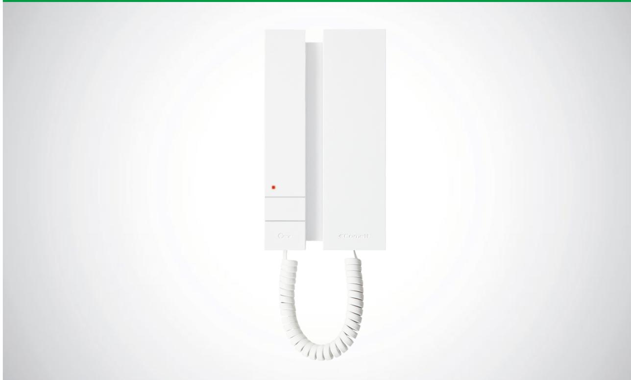
Citofono serie MINI per sistema Simplebus con chiamata elettronica, pulsante apriporta e pulsante supplementare per servizi aggiuntivi (chiamata centralino, attuatore, usi generici). Regolazione volume di chiamata e privacy tramite selettore a 3 posizioni. L'attivazione della privacy è segnalata da un'indicatore di colore rosso. Consente la gestione della chiamata fuori porta. Completo di dip-switch a 8 posizioni per la selezione del codice utente desiderato. Dimensioni: 105x191x28mm
