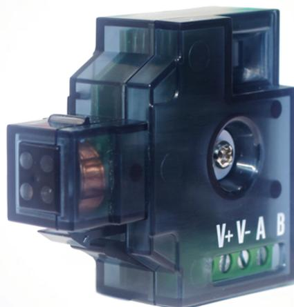
Lettores di prossimità per centrali di allarme serie Vedo collegabile sul BUS. Equipaggiato con LED di segnalazione in 4 colori (rosso, verde, giallo e blu) per la visualizzazione dello stato dell'impianto. Da utilizzare abbinato agli articoli SK9050. , inseribile su tutte le serie civili utilizzando il copriforo RJ45 Standard Keystone. Dim. 50 x 45 x 12.5 mm
