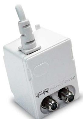
Il Minipower è un alimentatore di tipo Switching miniaturizzato, con un ingresso ed una uscita RF. Espressamente progettato per raggiungere altissima efficienza in un volume estremamente ridotto. L'alimentatore stabilizzato è protetto da eventuali cortocircuiti. Singolo ingresso ed uscita con la sezione Radio Frequenza completamente schermata per la prevenzione di qualsiasi eventuale interferenza proveniente dall'esterno.
