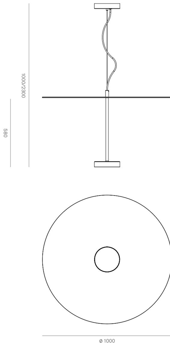
Artificio per il "trasporto indiretto di luce". Due dischi dialogano attraverso un asse verticale. La luce diretta emessa dal disco inferiore rimbalza sulla superficie del disco superiore inondando verso il basso l'ambiente in cui l'apparecchio è collocato.
