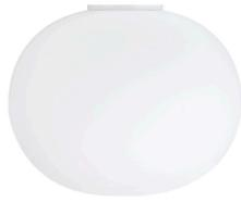
Apparecchio di illuminazione da soffitto a luce diffusa. Diffusore composto da un vetro opalino incamiciato, soffiato a bocca, con finitura esterna acidata e da una ghiera filettata in lega di alluminio pressofusa, con finitura galvanica "cromatazione alodine". Attacco a plafone composto da un elemento stampato ad iniezione in poliammide rinforzato con il 30% di fibra di vetro e supporto diffusore in lega di alluminio pressofusa verniciato di colore grigio a liquido.
