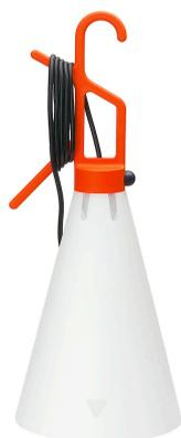
Apparecchio di illuminazione multiuso. Diffusore conico in polipropilene opalino stampato ad iniezione. Gancio/maniglia, avente anche la funzione di avvolgicavo, in polipropilene caricato talco stampato ad iniezione. Interruttore a pulsante situato sulla maniglia. Copertura interruttore in elastomero stampato ad iniezione.
